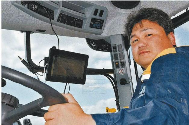
RTK-GPS のモニター画面がついたトラクターに乗り込む
